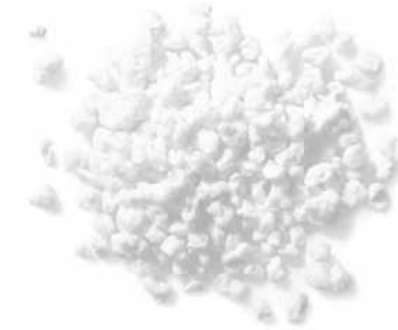
Perlite, hergestellt aus natürlichem Vulkangestein, ist die Basis für TecTem® Climaprotect.
